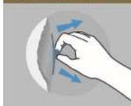
**Enlever** : Après l'application de la première couche de peinture et le séchage des cloisons sèches environnantes, retirer la couche protectrice transparente en tirant sur la languette.
