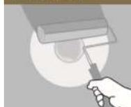
**Finition** : Peindre à nouveau avec deux épaisse couches de peinture de haute qualité en utilisant un rouleau et de la peinture au latex d'intérieur. ECLIPSE peut également être utilisé pour les murs et les plafonds texturés en utilisant des textures en aérosol ou des rouleaux de peinture texturés\*.
