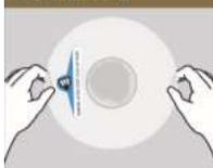
**Placer** : En tenant les bords extérieurs de la pièce, positionnez le cercle central gris de la pièce sur le centre du dommage sur le mur et utilisez votre main pour lisser complètement la pièce et la faire adhérer à la cloison sèche qui l'entoure. Appuyez fermement uniquement sur la zone où la pièce est en contact avec la cloison sèche. N'appuyez pas à travers la zone endommagée. N'enlevez pas la languette DAP ou la pellicule de protection avant la première couche de peinture.
